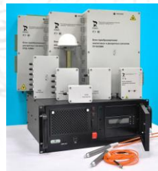
цифровой регистратор аварийных процессов ПАРМА РР4.11;
