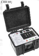
легкий и компактный микрометр, работающий от аккумулятора РЕТ-МОМ.2;
