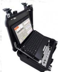
АnCom А-7/533200/307 — анализатор ВЧ-связи, PLC, кабелей связи и xDSL;
