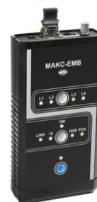
Устройство образования шлейфа и анализа трафика пакетных сетей MAKS–EMB;
